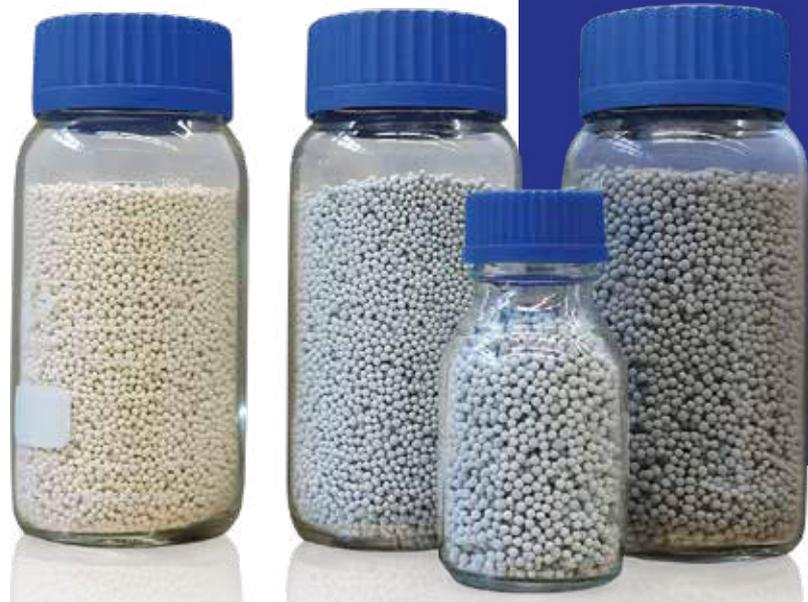
Heidrun Klostermann: „Wir beschichten das Zeolith-Granulat mit Aluminium – so konnten wir die Wärmeleitfähigkeit bereits im ersten Anlauf verdoppeln, ohne dass dadurch die Wasseraufnahme und -abgabe beeinträchtigt wird. Aktuell streben wir durch Anpassung der Schichten eine Steigerung um den Faktor fünf bis zehn an.“
