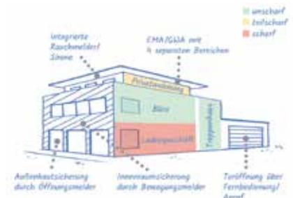
Das System ist in 4 Bereiche teilbar, die separat scharf oder unscharf geschaltet werden können.
