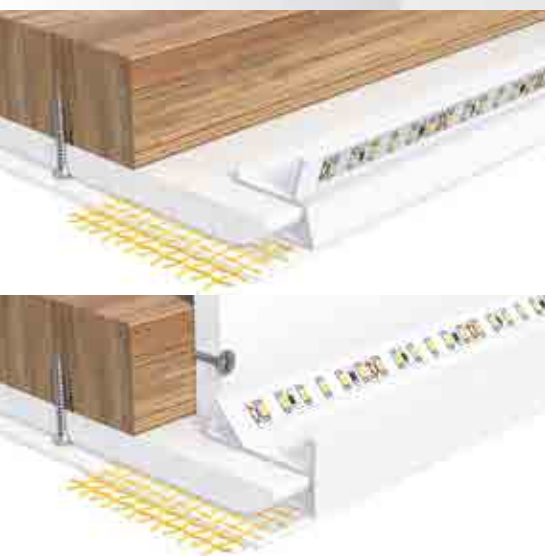
APTBU (oben) sorgt für eine optimale Voutenbeleuchtung der Wand, APTBHL (unten) dient zur Gestaltung von Decken gerichteten Lichtvouten.
