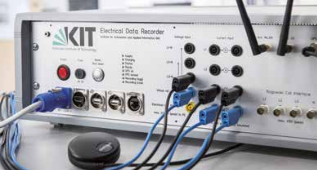
Der am KIT entwickelte Datenrekorder verwendet einen GPS-Empfänger und zeichnet Roh- und Frequenzdaten mit sehr hoher Auflösung auf. (Foto: Amadeus Bramsiepe, KIT)
