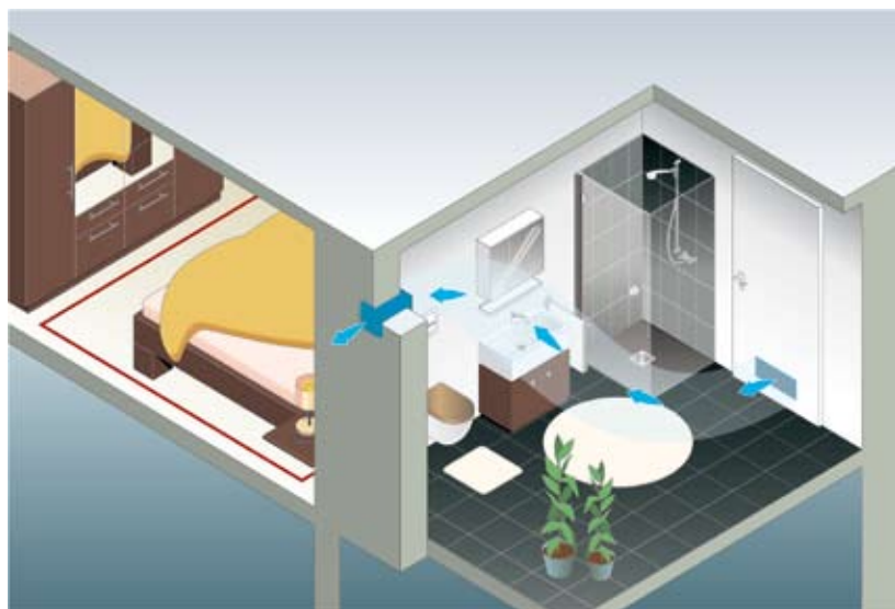
Das Nacht-Programm empfiehlt sich für Bäder, die an Schlafräume angrenzen: Während der Nutzung des Raumes entlüftet der Ventilator intensiv und schaltet nach Verlassen des Raumes in den leisen Nachlaufbetrieb.
